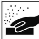
Загрунтованную поверхность шлифовать шкуркой с зернистостью 240-320. Избегать прошлифовки! Удалить древесную пыль.
